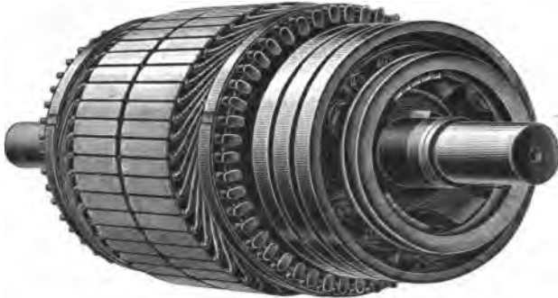
Rücklaufende Wellenwickelung (Falswicklung) der A. E. G.
